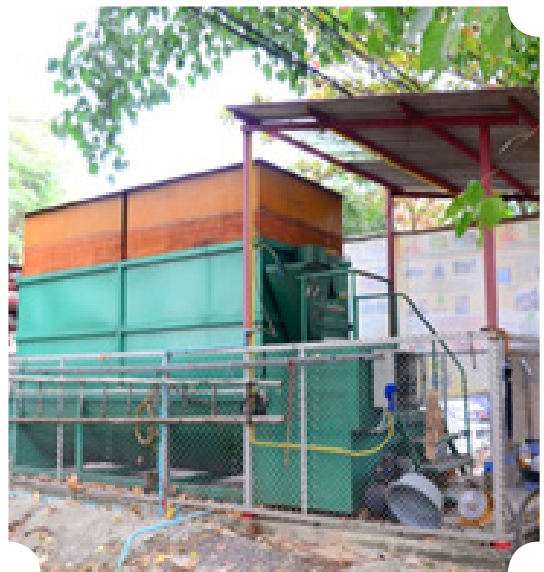
เครื่องทำปุ๋ยชีวภาพ จากเศษอาหาร และวัสดุจากธรรมชาติ
